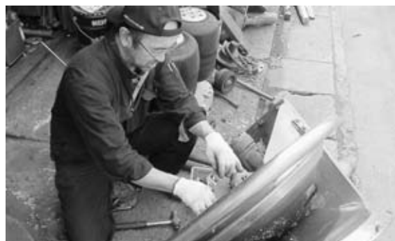
◀取り外した揚網機の修理
