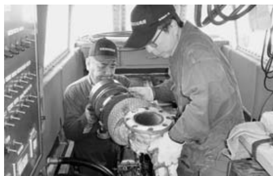
◀工場での修理のため、エンジンを取り外しているところ
