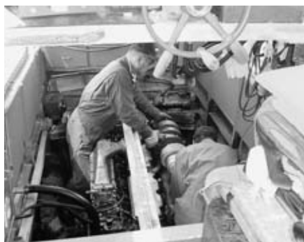
▶係留されたまま船舶内で行われるエンジンの修理
