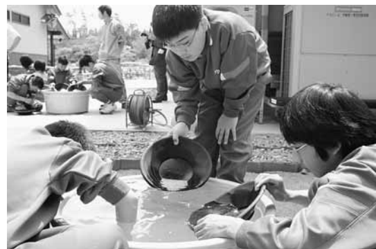
砕いた鉱石から不用物を流しさる「ゆりわけ～比重選鉱」の体験学習
